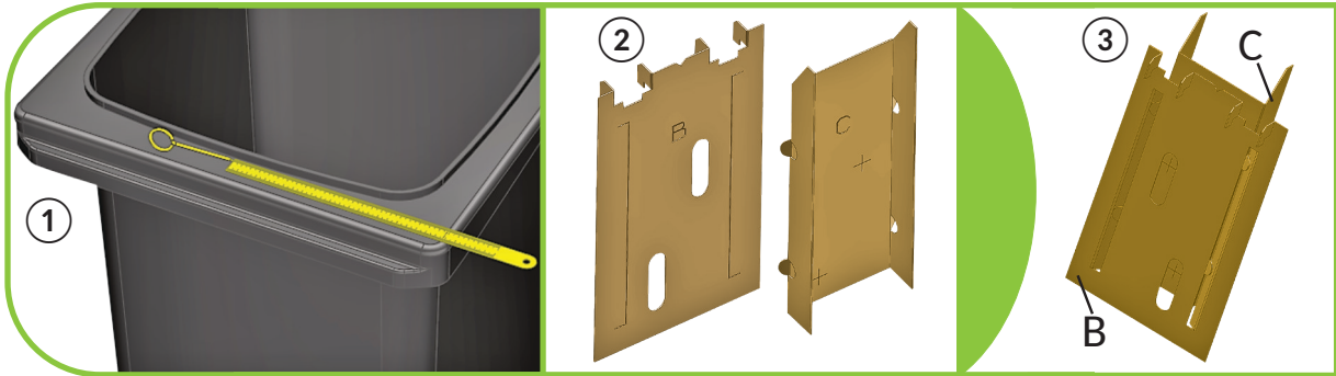
Mitte am Tonnenkörper markieren mark garbage can center
